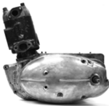
Рис. 2. Вид двигателя со стороны корзины сцепления
