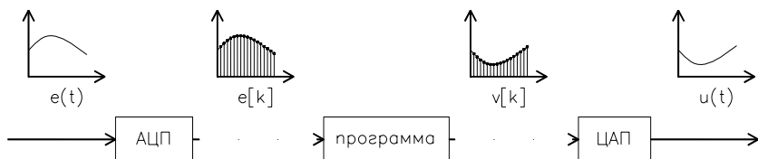
Рис. 3. Блок-схема цифрового компьютера
