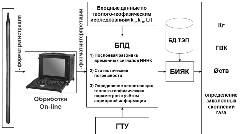
Рис.1. Схема технологии определения K_{\Gamma} по данным ИННК
