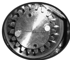
Вид стопорного винта ведущей шестерни до проведения доработки
