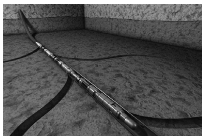
Рис. 3. Многозабойная скважина с системой «умного» заканчивания (Smart Well), участок Haradh Inc-3, месторождение Ghawar.
