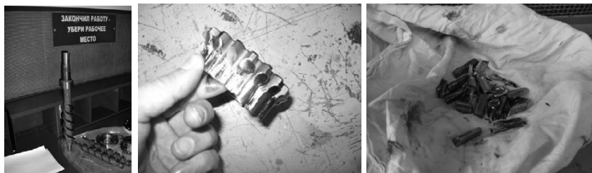
Рис. 7. Разрушение редукторной пары и главного вала трёх шпиндельного винтового насоса
