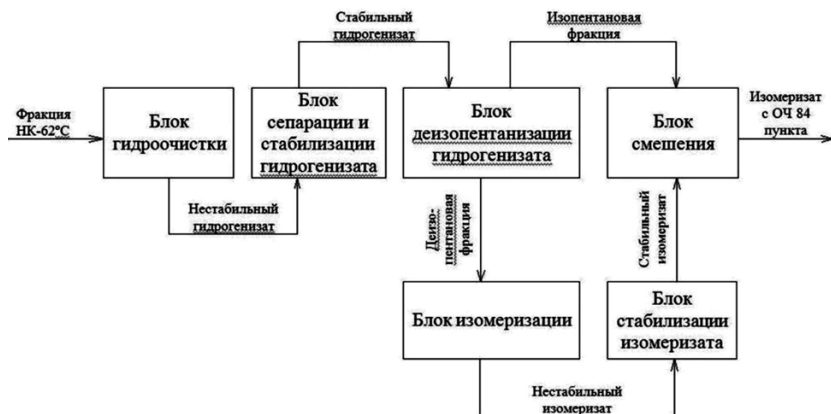
Рис. 1. Блок-схема установки низкотемпературной изомеризации фракции НК-62°С
