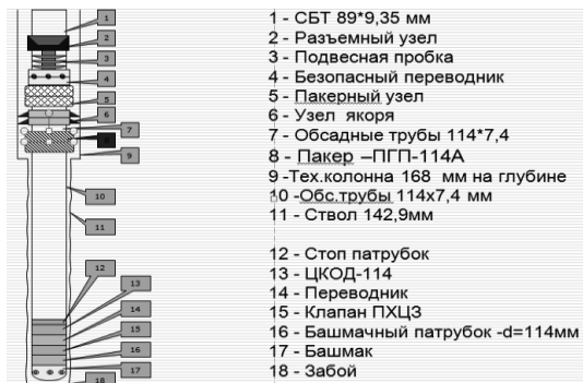
Рис. 5. Схема оснастки хвостовика при прямом цементировании
