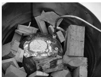
Фото 2, 3. Главный элемент установки - герметичный сосуд от водяного электронагревателя
