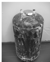
Фото 2, 3. Главный элемент установки - герметичный сосуд от водяного электронагревателя
